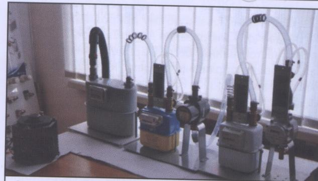
Рис. 3. Стенд для дослідження роботи побутових лічильників природного газу
