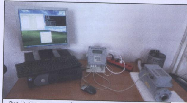
Рис. 2. Стенд для дослідження роботи комплексу вимірювання об’єму та об’ємної витрати газу на базі ультразвукового лічильника
